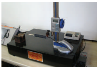
面粗さ計 金属表面粗さを測定します
