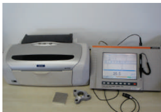
渦電流式膜厚計 非破壊式膜厚測定に使用
