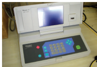
高抵抗低効率計 導電性アルマイトの表面抵抗の測定に使用
