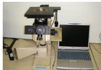
金属顕微鏡 破壊式膜厚試験に使用
